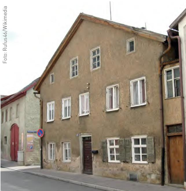
Das bedauernswerte Haus vor der Sanierung – im Sockelbereich erkennt sogar der Laie das feuchtegeschädigte Mauerwerk.
